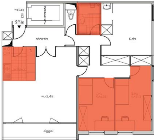
Zones d'intervention dans les logements en site occupé
