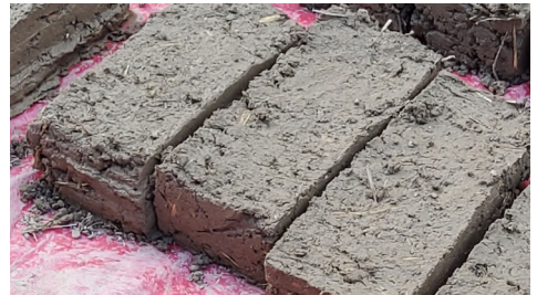
Unmolded bricks / Briques démoulées
